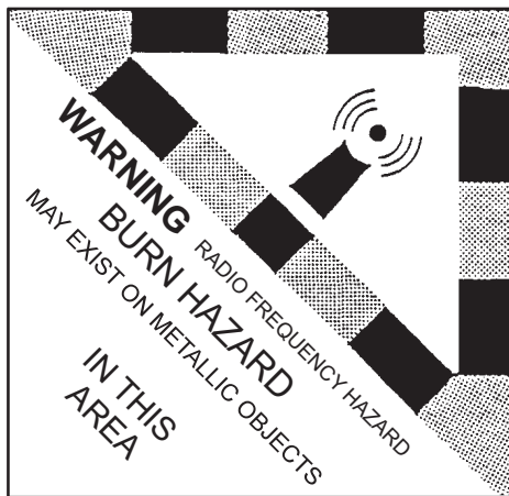
TYPE 3 - RF BURN HAZARD
